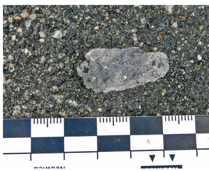
Abb. 3 a+b: Zementsteinabwitterungen oberhalb einzelner verwitterungsunbeständiger Gesteinskörner
