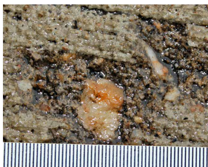
Abb. 4 a+b: Gesteinskörner mit einem dichtem Gefüge und einem hohen Frost-Tausalz-Widerstand im Zentrum von Zementsteinabwitterungen
