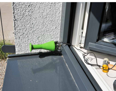
Abb. 8: Beispiel für eine elektrische Holzfeuchtemessung in der unteren Rahmenecke
